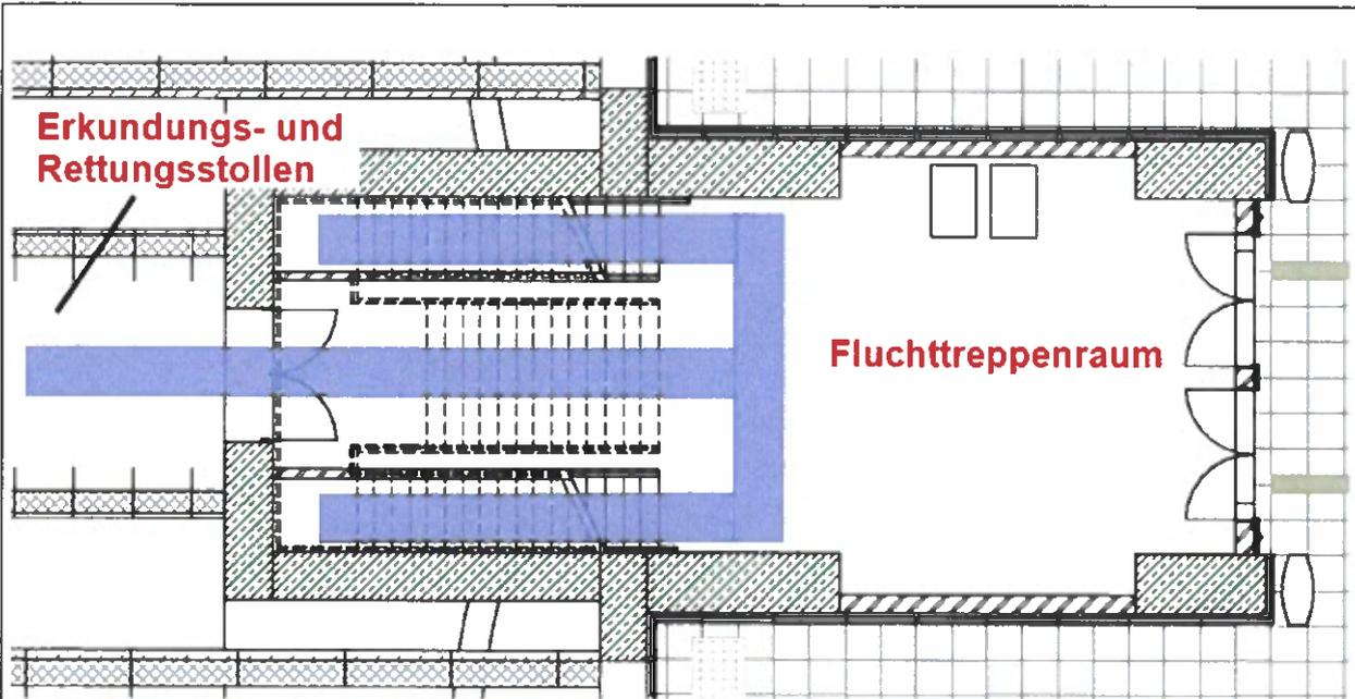
**Bild 14:** Anschluss des Erkundungs- und Rettungsstollens an den Fluchttreppenraum Mitte am westlichen Bahnsteigende der uPva MHPB (Grundriss, Prinzip)
