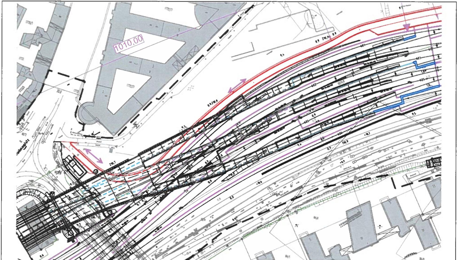
Bild 32: Fluchtweganordnung an den östlichen Portalen (Leuchtenbergring, Grundriss, Prinzip, türkis)
