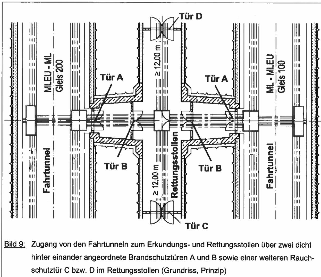
**Bild 9:** Zugang von den Fahrtunneln zum Erkundungs- und Rettungsstollen über zwei dicht hinter einander angeordnete Brandschutztüren A und B sowie einer weiteren Rauchschutztür C bzw. D im Rettungsstollen (Grundriss, Prinzip)
