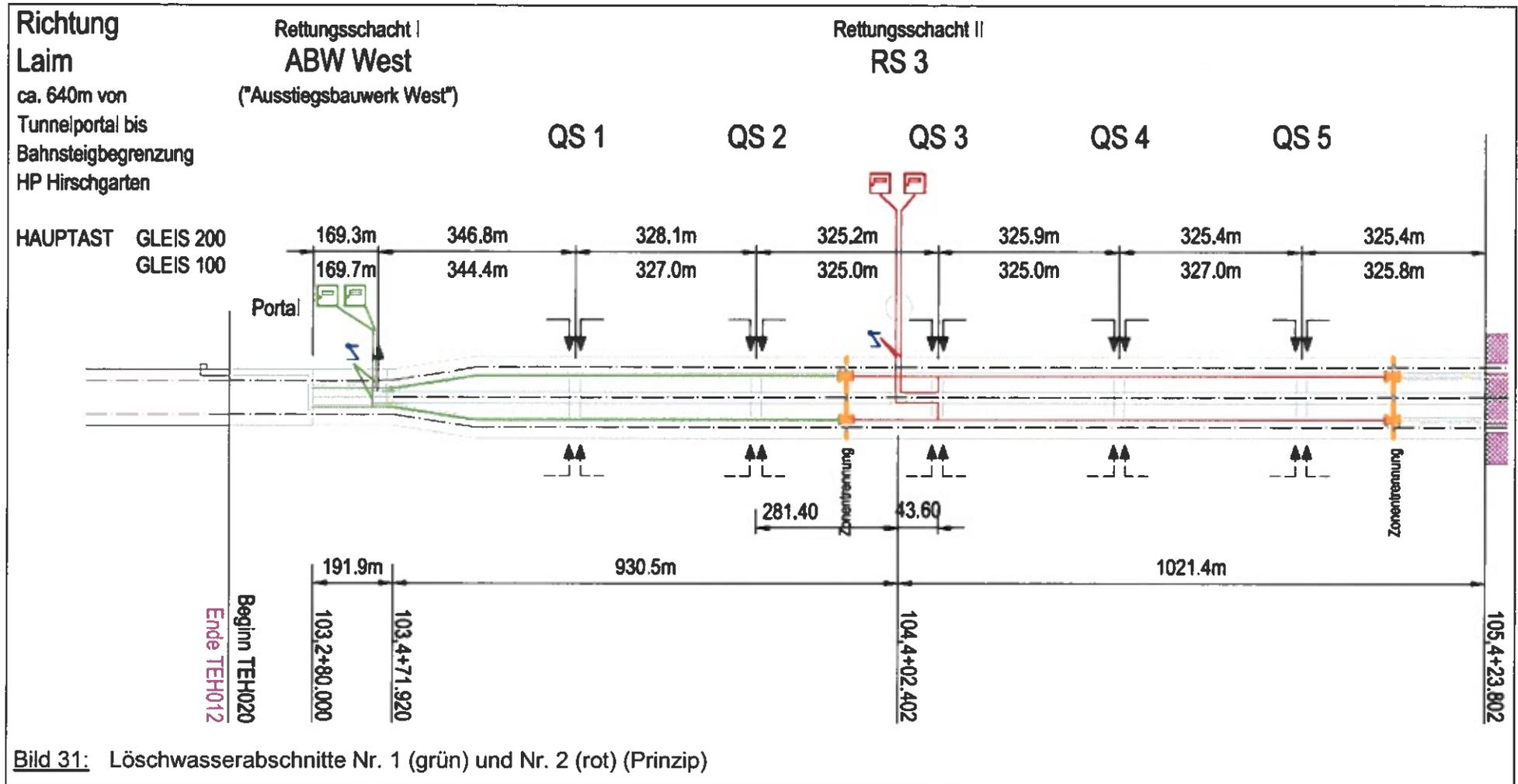
Bild 31: Löschwasserabschnitte Nr. 1 (grün) und Nr. 2 (rot) (Prinzip)
