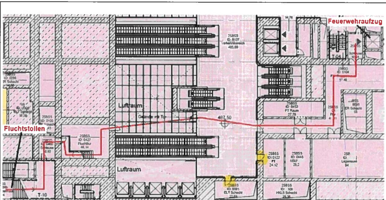
**Bild 15:** Laufweg in uPva MHPB vom westlichen Fluchtstollen zum Feuerwehraufzug (Grundriss, Prinzip)
